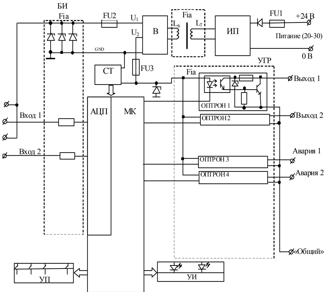
Рисунок 1 – Структурная схема преобразователя ET A 122O
