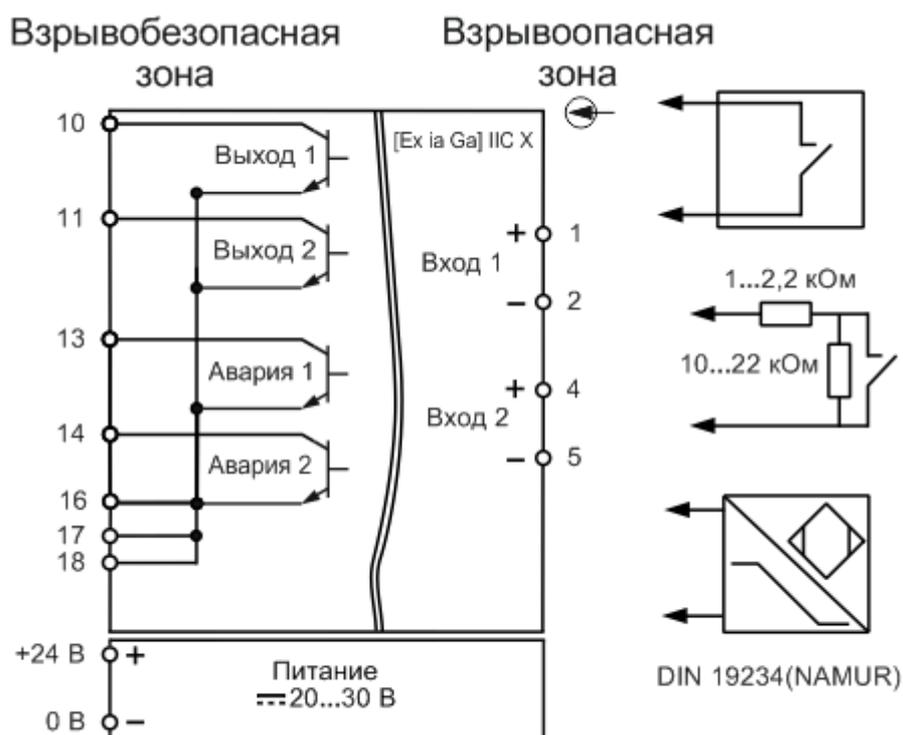
Рисунок В.1 – Схема подключения преобразователя ET A 122 O
