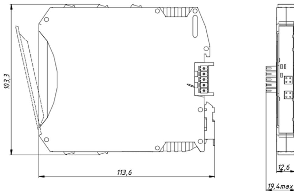
Рисунок А.1 – Габаритный чертеж преобразователя ЕТ А 122 О
