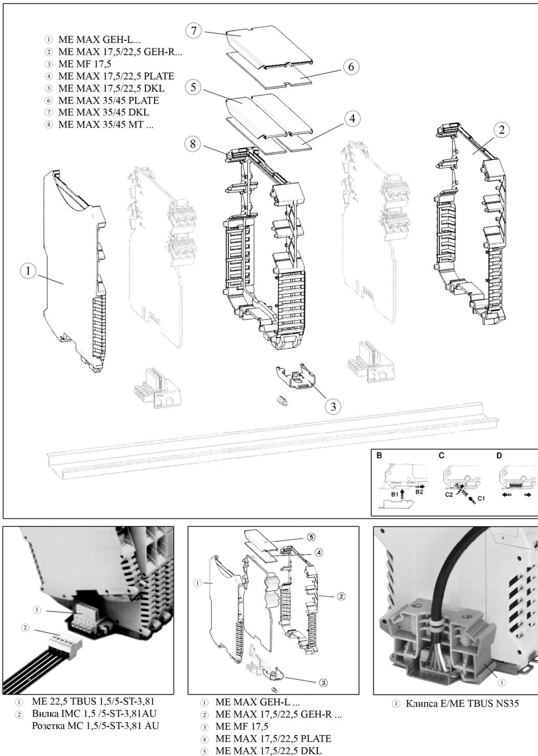
Рисунок Г.1 – Составные и дополнительные элементы корпуса *ME MAX 17,5 G 3-3*
