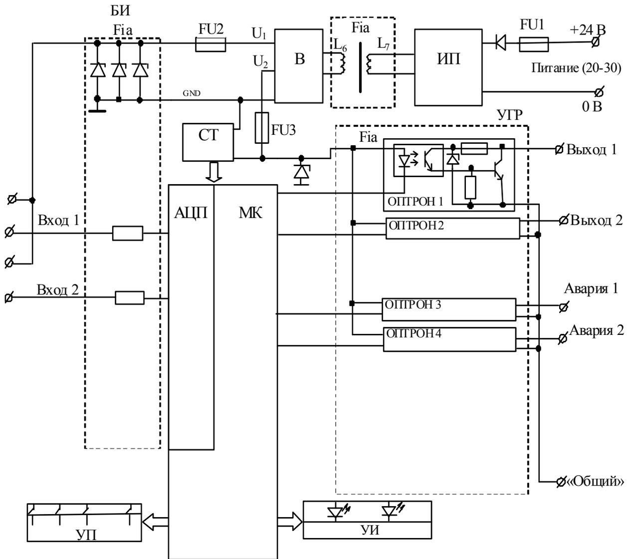
Рисунок 1 – Структурная схема преобразователя ЕТ А 122 О
