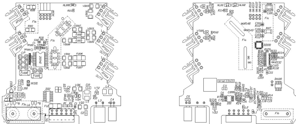
Рисунок Б.1 – Схема размещения элементов на плате преобразователя ET A 122 O
